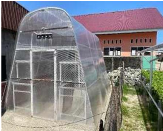
Gambar 3. Solar Dryer dome dengan rak pengeringan bertingkat
