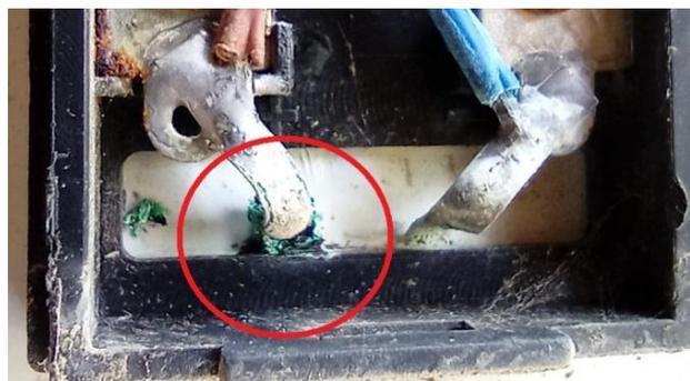
Gambar 4. Penampakan detail bagian panel surya yang bermasalah
