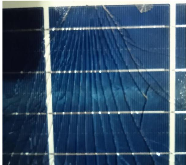
Gambar 7. Foto bagian panel surya yang pecah
