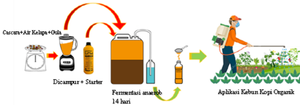
Gambar 1. Alur pembuatan biostimulan dari kulit buah kopi
